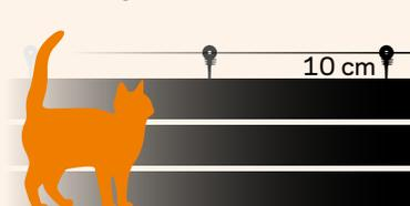
Abstand zwischen den Isolatoren: maximal 1 Meter.
